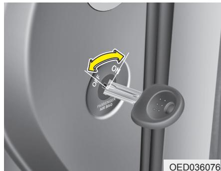
Для включения передней подушки безопасности пассажира необходимо вставить главный ключ от автомобиля в соответствующий переключатель, расположенный внутри перчаточного ящика и повернуть его в положение ON (Вкл.). Лампа, сигнализирующая об отключении передней подушки безопасности пассажира, погаснет.
