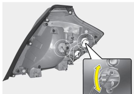
5. Снимите крышку и патрон из корпуса фонаря его поворотом против часовой стрелки, до совпадения выступов на крышке с канавкой на корпусе фонаря.
