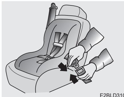
2. Вставьте язычок замка трехточечного ремня безопасности в пряжку. При соединении должен быть ясно слышен щелчок.
