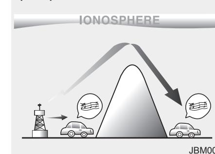
Сигналы AM (MW)-диапазона могут приниматься на большем удалении от радиостанции, чем сигналы FM-диапазона. Это возможно за счет более низкой частоты радиоволн AM (MW)-диапазона. Эти радиосигналы с большой длиной волн и низкой частотой распространяются не по прямой линии в атмосфере, а могут огибать земную поверхность. Кроме того, они огибают препятствующие их распространению объекты, что обеспечивает лучший прием сигнала.
