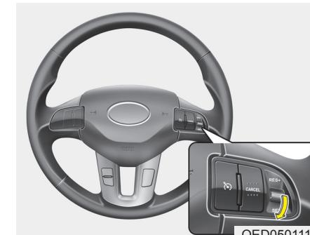
3. Нажмите выключатель SET- и отпустите его на нужной скорости. На приборной панели загорится контрольная лампа SET (Установка). Одновременно с этим отпустите педаль газа. Желаемая скорость будет поддерживаться автоматически.
