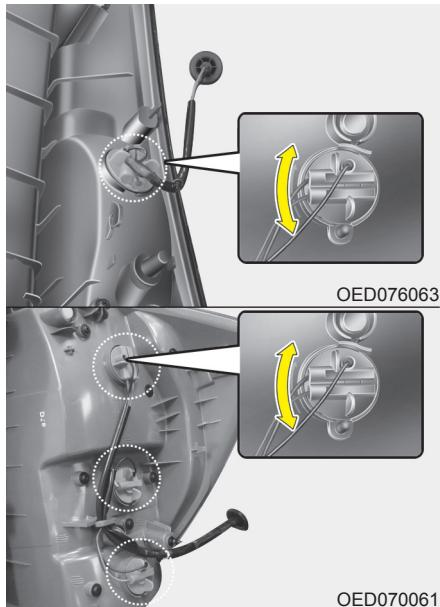
4. Выньте патрон из корпуса, поворачивая патрон против часовой стрелки до тех пор, пока ушки на патроне не совпадут с вырезами на корпусе.
