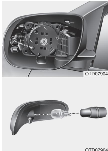
3. Открутить болт и затем вытащить линзу из корпуса.
