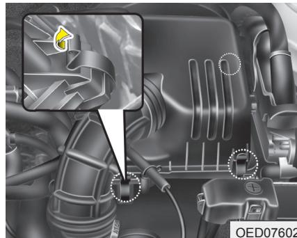
1. Отпустите защелки, крепящие крышку воздушного фильтра, и откройте крышку.
