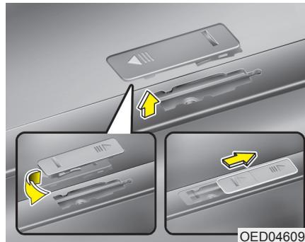
3. По окончании использования багажника опять установите крышку на крышу в обратной последовательности.
