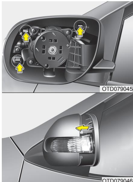
2. Снять покров с корпуса, нажав три 3 скобы-фиксатора.
