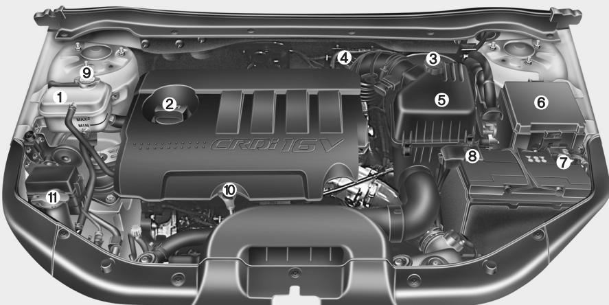
1. Бачок расширительный для охлаждающей жидкости
