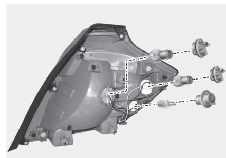
6. Снимите лампу из патрона нажатием и вращением до совпадения выступов на лампе с канавками на патроне. Вытяните лампочку из патрона.
