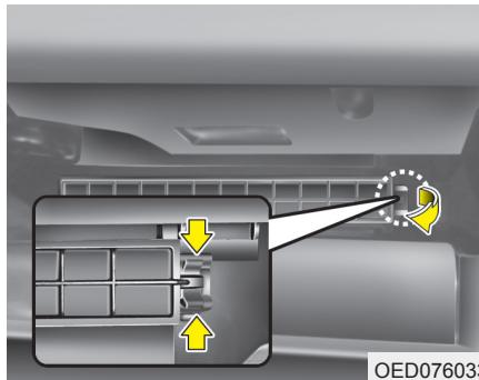
3. Вытяните крышку, нажав на крючки, расположенные с обеих сторон корпуса фильтра системы вентиляции.
