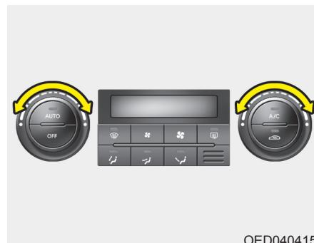
Левая рукоятка используется для регулировки температуры на месте водителя.
