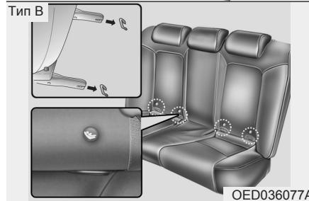
На нижней части задних сидений с обеих сторон расположены маркеры детских ремней безопасности, отмечающие места крепления нижних фиксаторов ремней безопасности для детей, установленных подобным образом.
