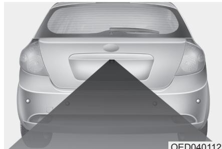
Это вспомогательная система, позволяющая видеть пространство позади автомобиля на экране мультимедийной системы при движении задним ходом.
