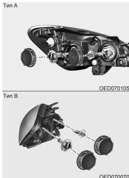
5. Снимите крышку лампы фары, повернув ее против часовой стрелки.
