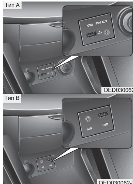
**Порты: для дополнительных устройств, USB и iPod (при наличии)**
