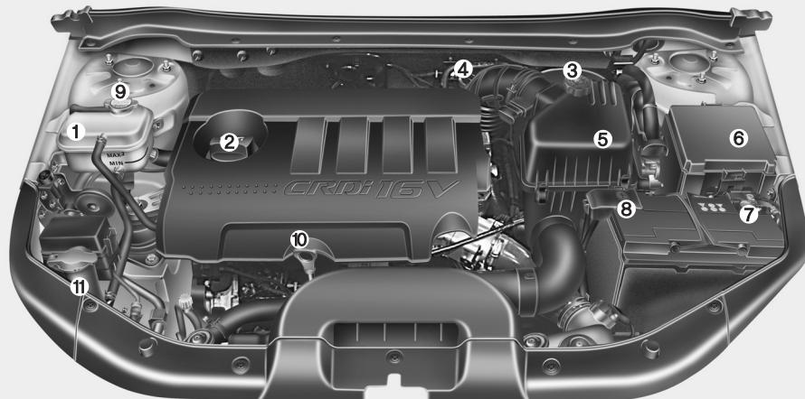
1. Расширительный бачок системы охлаждения двигателя ..... 7-34
