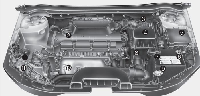
1. Бачок расширительный для охлаждающей жидкости
