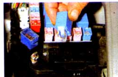
...вынимаем реле из колодки. Если реле не удастся извлечь из колодки, можно аккуратно поддеть его отверткой, вставив ее между корпусом реле и колодкой.
