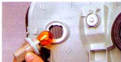
...и вынимаем его из корпуса блок-фары.
