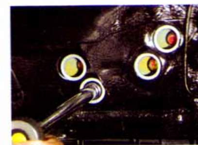
Головкой «на 14» с удлинителем отворачиваем четыре болта крепления левой опоры силового агрегата к кузову.
