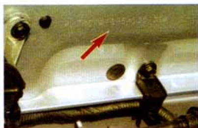
Идентификационный номер автомобиля (VIN) выбит в моторном отсеке, сверху справа на щитке передка
