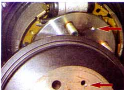
...на совпадение отверстий в ступице и барабане.
