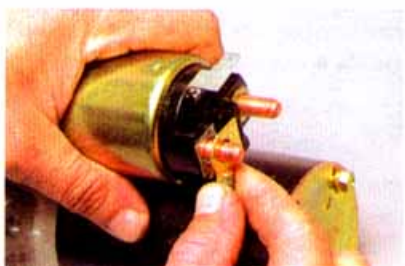
...и снимаем наконечник с вывода.
