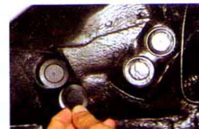
Вынимаем четыре резиновые заглушки отверстий под болты крепления опоры.
