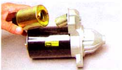
...и снимаем тяговое реле стартера.
