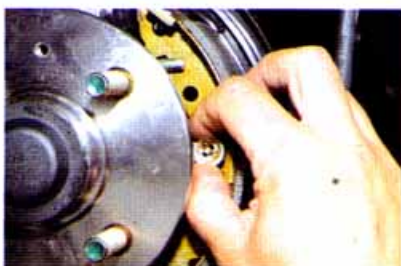
Придерживая опорную стойку передней колодки с обратной стороны тормозного щита, нажимаем на шайбу и поворачиваем ее до совмещения прорези шайбы с хвостовиком стойки.
