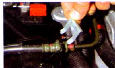
...снимаем стопорную пластину верхнего наконечника шланга привода сцепления.
