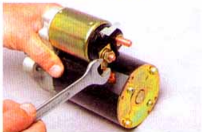
...ключом «на 12» отворачиваем гайку крепления наконечника провода к выводу тягового реле...
