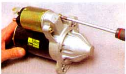
Крестообразной отверткой отворачиваем два винта крепления...
