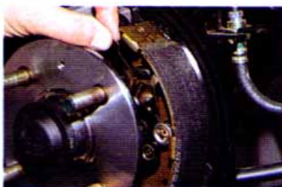
Снимаем рычаг регулятора.
