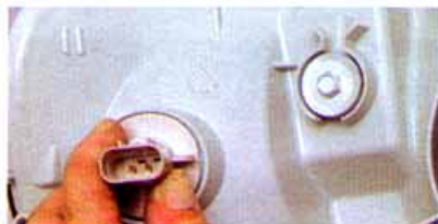
...поворачиваем патрон лампы против часовой стрелки на 45°...
