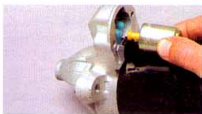
Снимаем якорь тягового реле. Устанавливаем тяговое реле на стартер и стартер на автомобиль в обратной последовательности.
