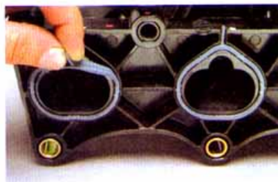
...вынимаем их из канавок выпускного трубопровода. Заменяем прокладки новыми. Устанавливаем впускной трубопровод и снятые детали в обратной последовательности.
