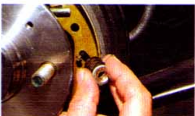
Снимаем шайбу с пружиной... ...и опорную стойку.
