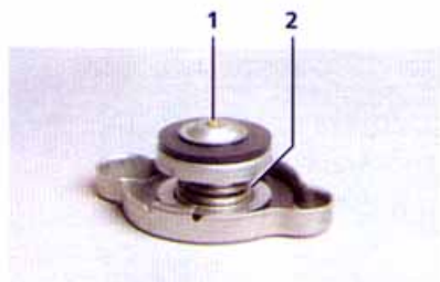
Пробка радиатора: 1 — впускной клапан; 2 — выпускной клапан
