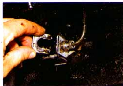
...снимаем стопорную пластину шланга.
