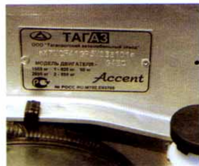
Данные об автомобиле приведены в табличке, прикрепленной к щитку передка с левой стороны
