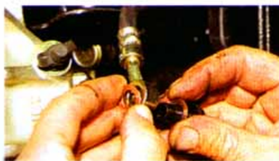
С обеих сторон наконечника установлены медные уплотнительные шайбы.
