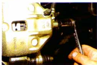
Головкой «на 12» отворачиваем болт-штуцер наконечника шланга тормозного механизма.
