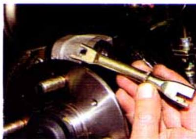
Снимаем распорную планку. Снимаем с тормозного щита заднюю колодку так же, как переднюю...
