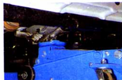
Устанавливаем домкрат под картер сцепления и слегка поднимаем силовую агрегат, разгружая его левую опору.
