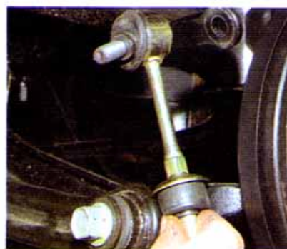
Снимаем стойку стабилизатора.
