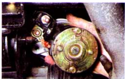
...и снимаем стартер. Для замены тягового реле...
