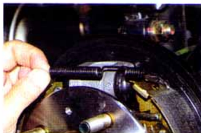
...снимаем верхнюю стяжную пружину.
