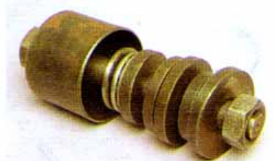
Съемник чашечный для выпрессовки и запрессовки подшипника передней ступицы
