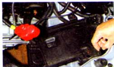
...и отводим поддон в сторону (к нему прикреплены держатели жгутов проводов). Поддев отверткой...
