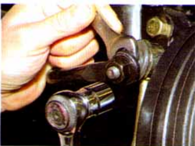
Снимаем нижнюю подушку стойки.
