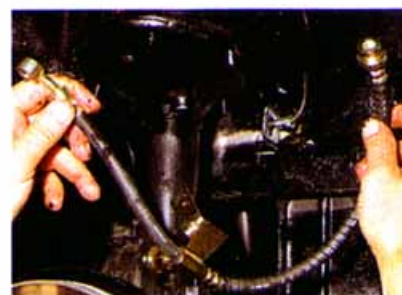
...и снимаем шланг. Устанавливаем шланг в обратной последовательности, не допуская его перекручивания. Прокачиваем систему гидропривода тормозов, замена тормозной жидкости», с. 34). Осматриваем места соединений шланга, при необходимости подтягиваем штуцер трубки и болт-штуцер.
