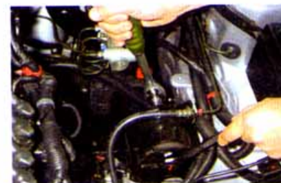
Головкой «на 17» отворачиваем гайку болта крепления опоры к кронштейну на коробке передач, удерживая болт от проворачивания ключом того же размера.
