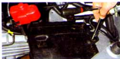
Ключом «на 12» отворачиваем два болта крепления поддона аккумуляторной батареи...
