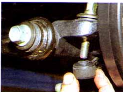
Снимаем нижнюю подушку стойки.
