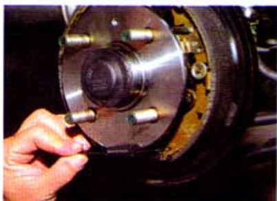
Аналогично снимаем нижнюю стяжную пружину.
