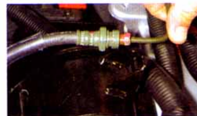
Вынимаем наконечник шланга из держателя.
