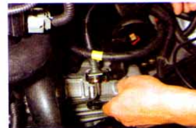
Головкой «на 12» отворачиваем болт крепления держателя нижнего наконечника шланга... и снимаем держатель.
