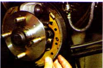
Снимаем переднюю тормозную колодку.
